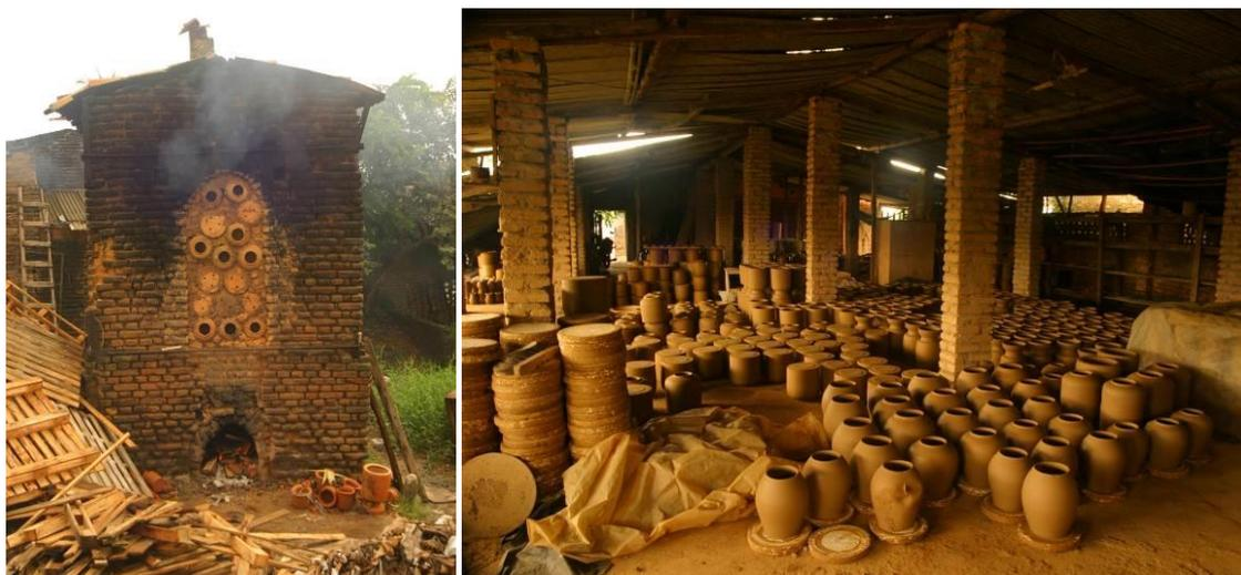
*Figura 6. Forno de queima da cerâmica (esq.) e área de produção em uma olaria do Mauriti.
