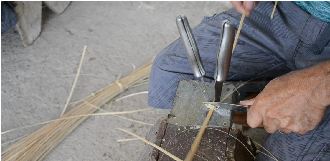
Figura 18 – Arranjo de facas para padronizar as paletas Fonte: Acervo Laboratório O Imaginário, 2016
